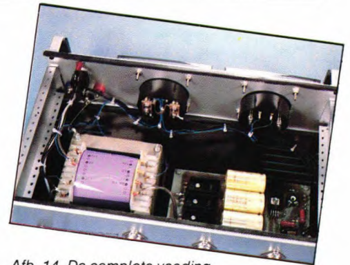
Afb. 14. De complete voeding, zonder bovenzijde. Op de achtergrond is het front te zien met de bekabeling.
